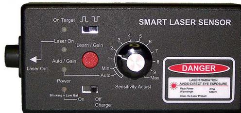
Der Smart Laser Sensor ist ein batteriebetriebener, optischer Drehzahlsensor der Laser Klasse 3R, 3mW Power. Die Signale können als TTL-Signale ausgegeben werden. Entfernungen bis zu 20m zum erfassenden Objekt sind zulässig. Mitgelieferte Reflektiertapes können auf das Objekt aufgebracht werden. Bei genauer Zielerfassung leuchtet eine LED auf.
