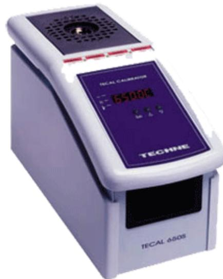
Die Temperatur-Kalibratoren der Modellreihe Tecal zeichnen sich durch hohe Genauigkeit und Langzeitstabilität, Flexibilität und Bedienungsfreundlichkeit aus. Austauschbare Thermoblocks mit verschiedenen Bohrungen für die zu kalibrierenden Fühler und ein Bereich der geregelten Temperaturzone von 50 mm eröffnen diesen Kalibratoren ein weites Einsatzfeld.
