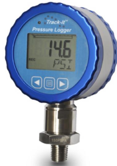
Die austauschbare interne Lithium-Batterie hat eine Lebensdauer von bis zu 3 Jahren. Die Datenlogger sind auch mit der Track-It Transport Android- Software kompatibel.
